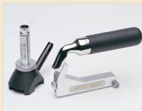
5. Con el factor de escala (número de \mu\text{m} o milipulg. por división), calcule el espesor del revestimiento de cada capa.
